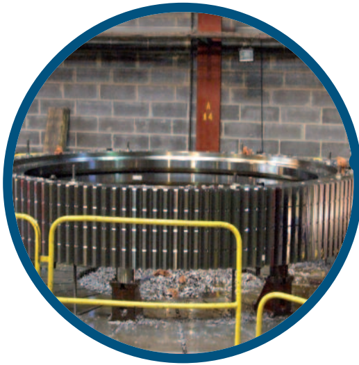
Taillage de bagues d'éoliennes 10 tonnes EN GJS 400-18U LT
